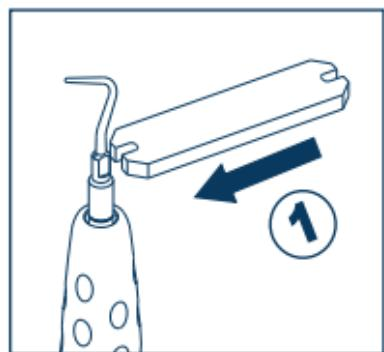
**Fig. 6 - Colocando a chave.**
