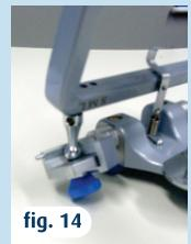
3 - Ajuste as guias condílicas com uma angulação de 30° e a angulação lateral (BENNETT) negativa (figs. 15 e 16), de modo que o articulador fique estável na posição central. Em seguida, fixe o puxador da mola no pino do ramo inferior. (fig. 17)
